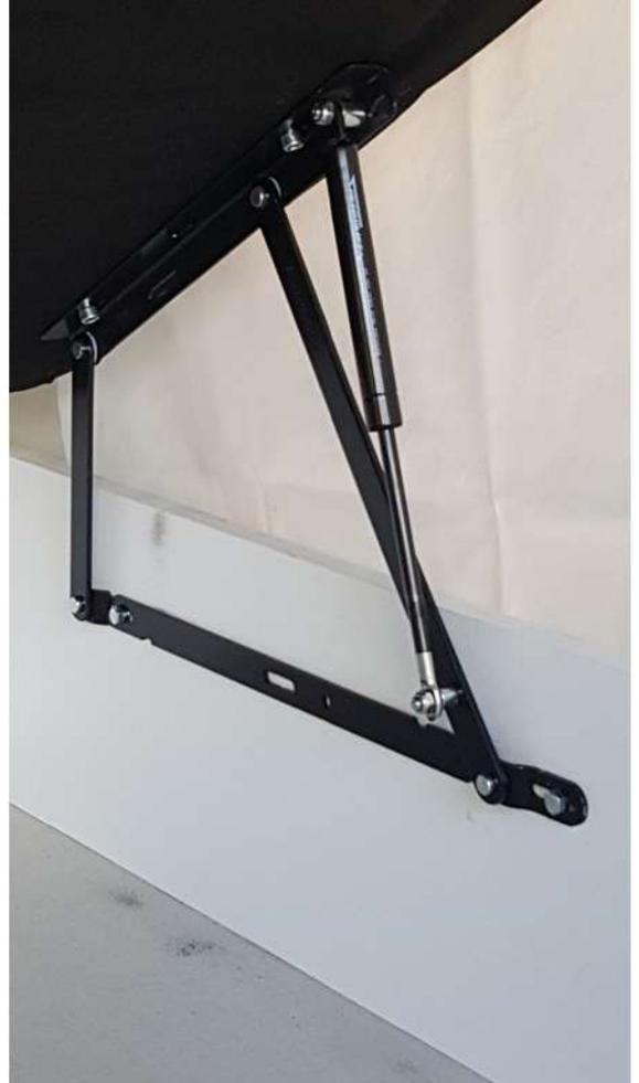
**5.** Montar tapa encima del amortiguador, fijandola con tornillos.
